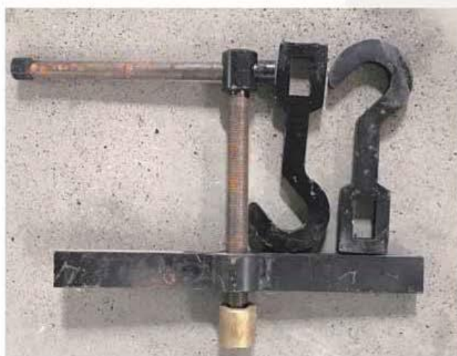
Standard shaft drawing die 校轴拉模
